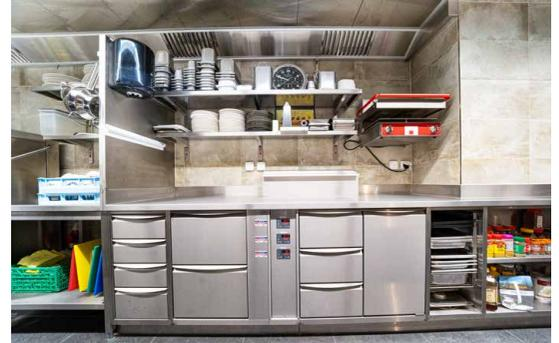
Tout ce qu'il faut pour garantir des processus rationnels dans une cuisine professionnelle: fourneau suisse à plaques de cuisson à induction, Swiss Indu-Griddle, tiroirs chauffe-plats et dépôts de casseroles dans la partie inférieure du fourneau, salamandre, Hold-o-mat et steamer combiné Practico Vision Plus.
