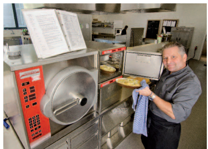
Drei Kombisteamer, drei Flexipfannen, zwei Hold-o-maten und ein Drucksteamer bilden die Produktionsstrecke für das Banketting.
