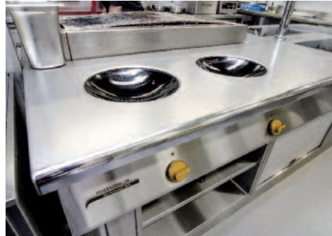
Der multifunktionale und massgeschneiderte «Schweizer Herd» von Hugentobler steht im Mittelpunkt der zentralen Küche. Er ist in seinen Funktionen nach den spezifischen Bedürfnissen des Betriebs konfiguriert: Gas-Lavastein-Grill, Induktions-Wok, flächendeckende Induktionskochfelder und Ceran-Grosskochfeld, das auch als Wärme- und Anrichtefläche genutzt werden kann.
